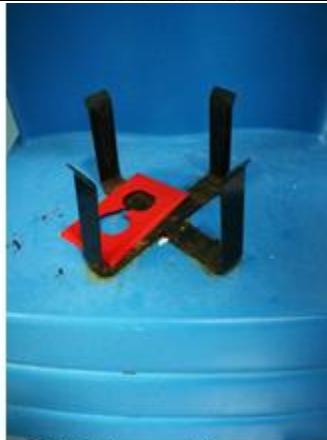
Foto 22 – Equipo con oxido en zona estéril
