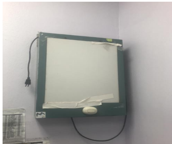
Fotografía #21: Negatoscopio del consultorio # 5 dañado
