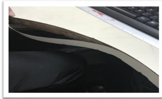
Fotografía 3 Forros de los muebles desprendidos en cubículo de la Subárea Caja y Custodia de Valores
